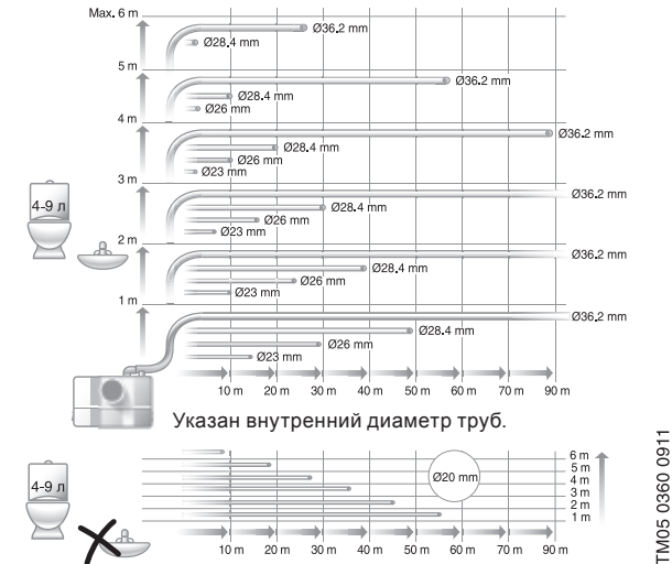
Рис. 55 Максимальная длина вертикальных и горизонтальных сливных труб
