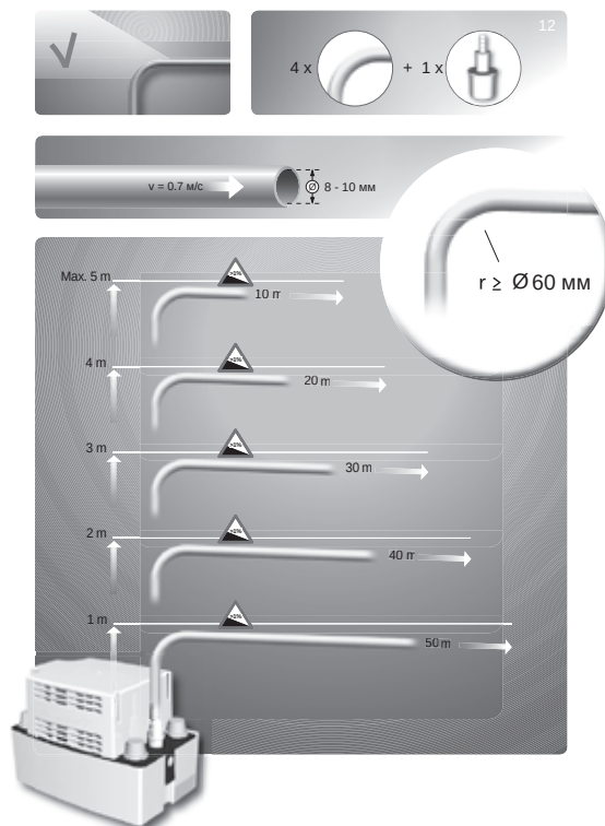
Рис. 71 Максимальная длина вертикального и горизонтального напорных шлангов
