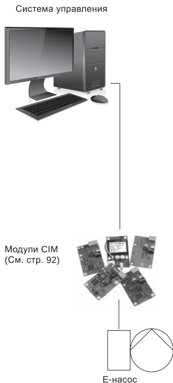
Рис. 12 Структура центральной системы управления
