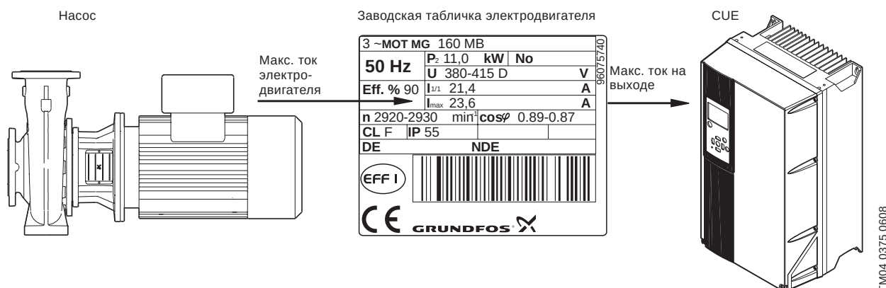
Рис. 143 Подбор CUE на основании максимального тока электродвигателя.
